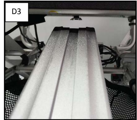
Conectar la batería (D1) en el extremo de la ranura en forma de T en el fondo de la cubierta de la batería alineada con el carril de guía en forma de T en la parte inferior del asiento.
