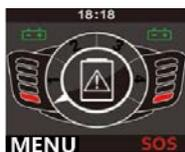
1, Si el indicador de batería está en rojo, cargarla lo antes posible, reducir el uso de la función de conducción y cambiar a modo empujar la silla de ruedas. De no hacerlo, se podría ver atrapado en un lugar poco seguro, como en medio de una carretera.
