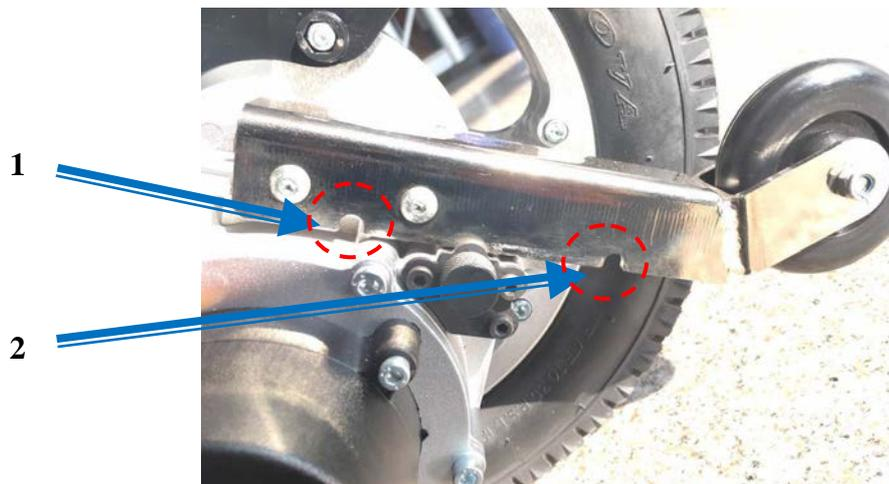
1. Como se indica en la Fig.- G1, apretar el botón de la rueda anti-vuelco. Colocar la rueda anti-vuelco en la posición del orificio para que quede fijada.
