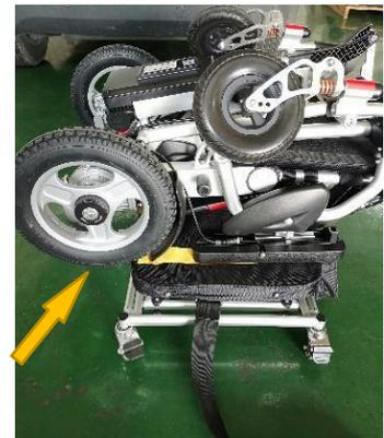
A4. Coloque la silla de ruedas sobre el tablero en posición invertida como se muestra en la imagen, con las ruedas en contacto con el borde del tablero.
