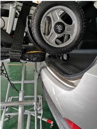
A8. Sitúe la plataforma al lado del maletero y ajuste su altura, como se muestra en la imagen, hasta que la ruedecilla antivuelco de la silla de ruedas pueda entrar en el maletero.
