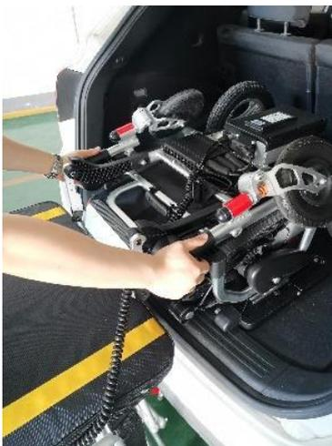
A12. Sujete la silla de ruedas con las manos en la posición que se muestra en la imagen para levantarla.
