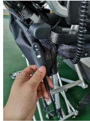
A10. Introduzca el mando a distancia en la bolsa para la batería a fin de evitar daños.
