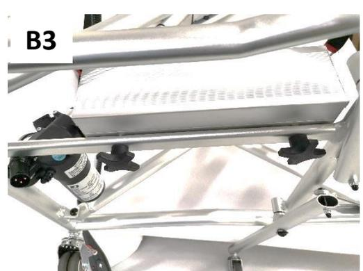
2. Inserte los dos tornillos de la batería en los agujeros correspondientes del bastidor y apriete el pomo. Asegúrese de que la batería esté instalada en la misma dirección que se muestra en la Figura B.
