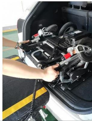
B7. Sujete la silla de ruedas con las manos en la posición que se muestra en la imagen para levantarla. Extraiga la silla de ruedas del maletero y sitúela sobre la plataforma.
