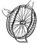
Coloque el fondo de la llanta en posición por encima de la válvula de aire antes de insertarlo en la llanta. A continuación, el fondo de la llanta se puede colocar por encima fácilmente. Compruebe que todos los extremos de los radios están cubiertos (el fondo de la llanta no es necesario en el caso que la llanta sea de plástico).
