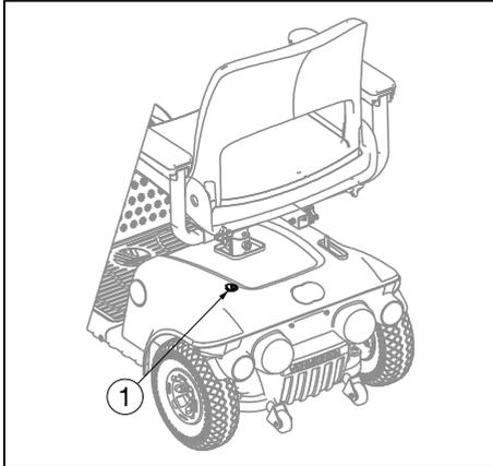
Para proteger el motor de sobrecargas, el scooter dispone de un mecanismo térmico de seguridad ① en su parte posterior. El fusible térmico parará el motor automáticamente para evitar el recalentamiento, el deterioro rápido o las averías. Puede acceder al dispositivo térmico de seguridad a través de un orificio situado en la parte posterior de la cubierta sintética.
