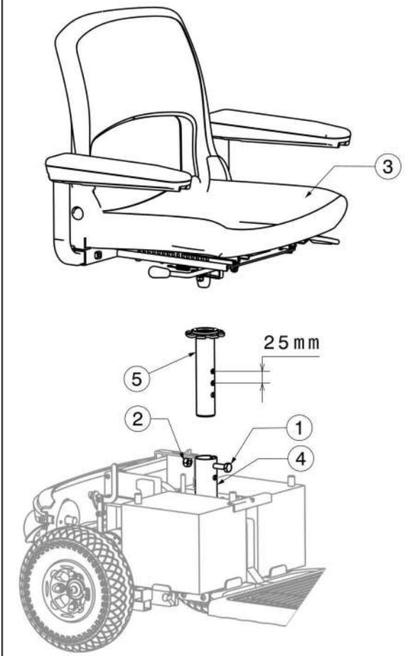
**Ajuste de la altura del asiento (Fig. B)**
