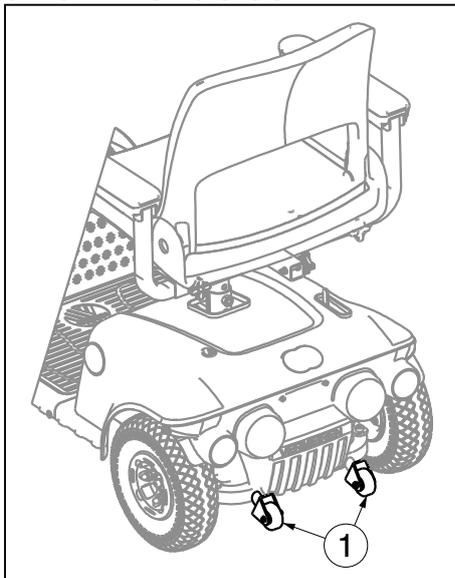
El antivuelco ① está fijado en la parte posterior del armazón del scooter, por lo que no es posible extraerlo. Por lo tanto, no es posible retirarlo. El antivuelco está diseñado para su seguridad. Evita que el scooter vuelque hacia atrás cuando supere obstáculos pequeños que NO excedan la altura máxima especificada.
