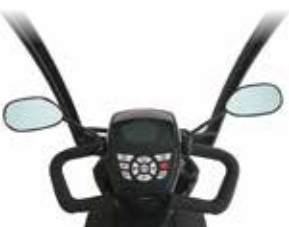
Espejos retrovisores, selector de modo de conducción y tablero
